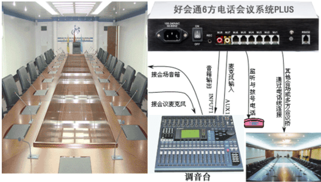
好会通 PLUS 系统与会议室音响系统结合电话会议应用方案
